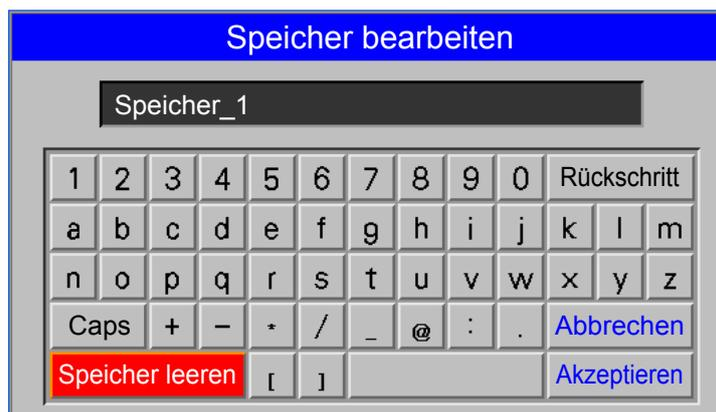
Drücken Sie zur Anzeige des Fensters Speicher bearbeiten und der virtuellen Tastatur die ENTER-Taste. Wählen Sie mit ▲▼◀▶ die gewünschte Einstellung und drücken zum Bestätigen ENTER-Taste.
